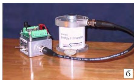
Рис. 23. а — Схема устройства для сбора паразитных магнитных полей; магнетостриктивный материал (1); направление поляризации (2); направление магнитной индукции (3); пьезоэлектрик (4); б — магнетоэлектрическое устройство, собирающее энергию вибрации, изготовленное фирмой Ferro Solutions (США) (взято с сайта <http://www.ferrosi.com>).
